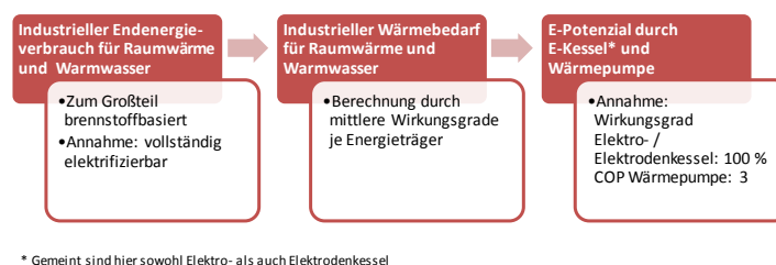
Abbildung 7: Methodik zur Ermittlung des Elektrifizierungspotenzials brennstoffbasierter Raumwärmeezeugung
